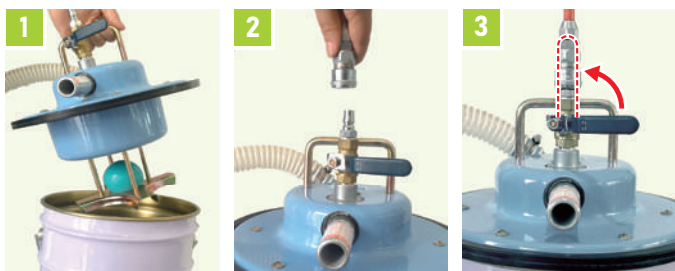
1 Đặt đầu máy lên thùng xô 20 lít 2 Kết nối đầu dây khí nén 3 Mở van để bắt đầu quá trình hút
