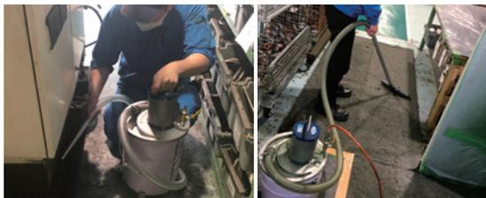
Karena berpenggerak udara, alat ini dapat digunakan dengan aman di area yang tahan ledakan. Dengan desain struktur yang sederhana, alat ini juga tahan terhadap lingkungan yang keras dan mengurangi biaya perbaikan.
