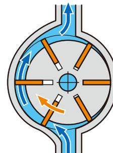
ポンプ本体の中心と羽根車の中心が少しずれており、遠心力により可動するベーン(翼)が飛び出るような構造をしているポンプです。容積をベーンによって小さくすることにより圧力を上昇させる動作原理を採用しています。
